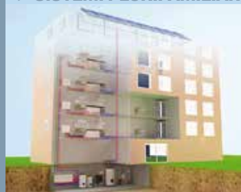
Impianto solare Multifamily a scarico inerziale
