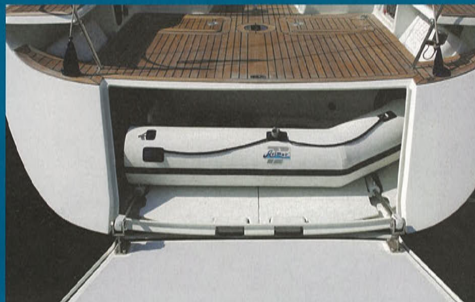
Sullo specchio di poppa si apre un imponente portellone che fa accedere al tender garage.
