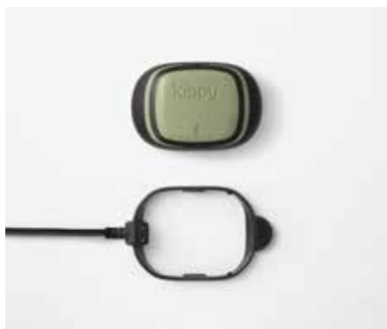
▲ Per la sezione elettronica e PET design. Kippy è GPS e Activity tracker, è un localizzatore e tracciante delle attività del proprio cane in tempo reale. Piccolo, adattabile ad ogni collare, impermeabile e con una batteria fino a 10 giorni di durata.
